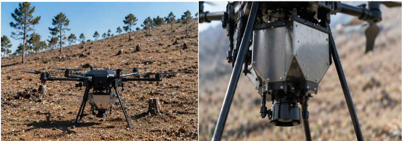
Figura 43. Dron heavy-lift për pyllëzim inteligjent me sistemin e shpërndarjes së materialit mbjellës (dispenser)
