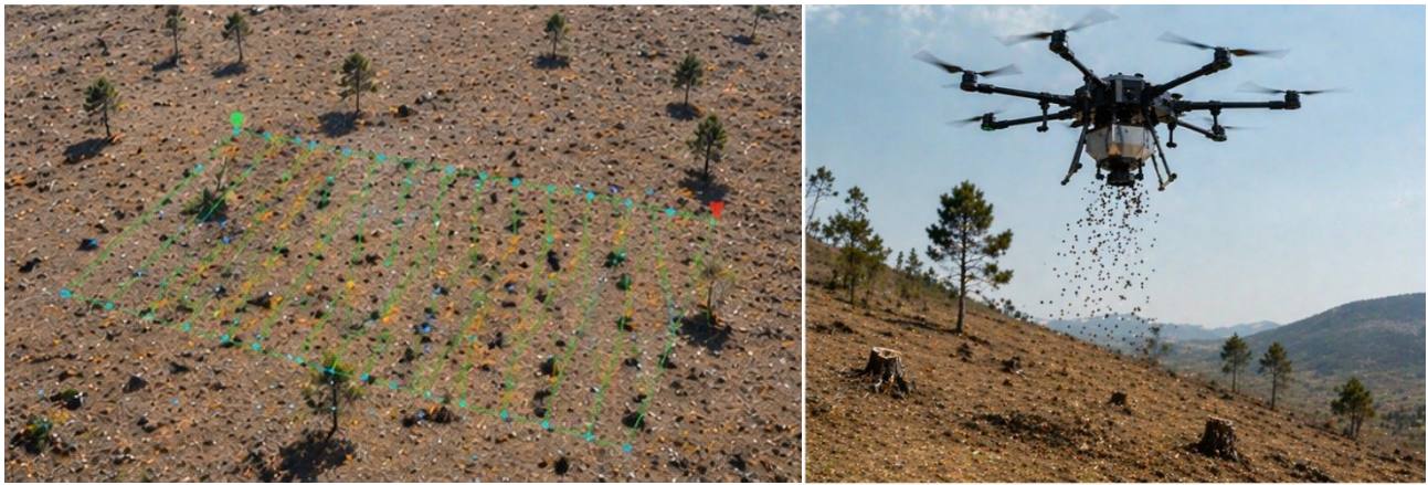
Figura 44. Planifikimi i mbjelljes në rrjet mbi parcelë përmes analizës gjeohapësinore dhe mbjellja ajrore me dron
