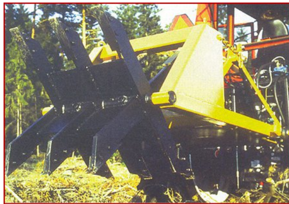
Figura 1: Pastrimi i mbeturinave dhe shkulja e mekanizuar e cungjeve
