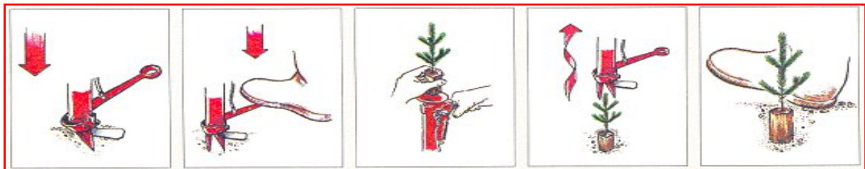
Figura 24. Tubi mbjellës (pottiputki) dhe përdorimi i tij
