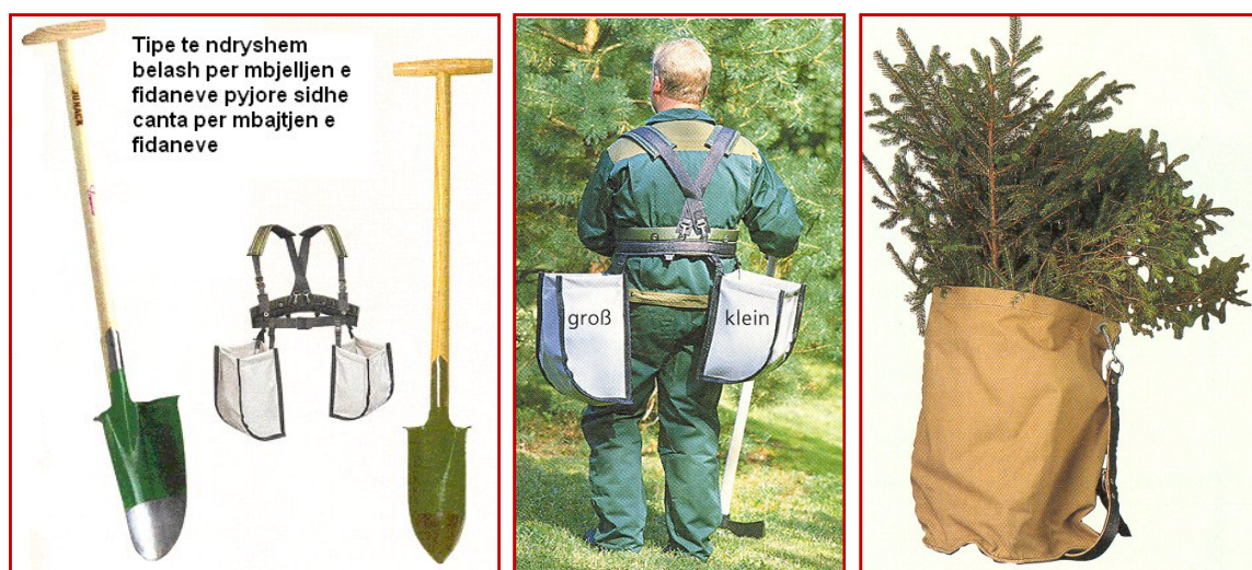
Figura 27. Tipa të ndryshëm belash pyjorë dhe çanta për mbajtjen e fidanëve
