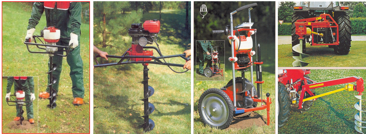
Figura 23. Hapja e mekanizuar e gropave me tryelë motorike
