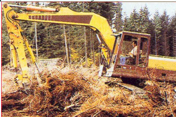
Figura 1: Pastrimi i mbeturinave dhe shkulja e mekanizuar e cungjeve
