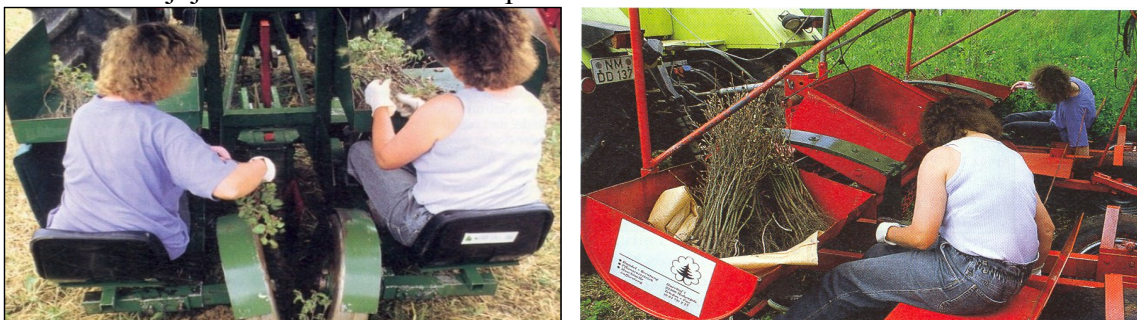
Figura 30. Makinë mbjellëse fidanësh
