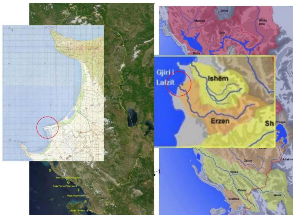
Figura 5 - Prerja e kanalit dhe erozioni bregdetar në lumin Erzen –Gjiri i Lalzit (1984 – 2015) (G. Zolezzi, 2019)
