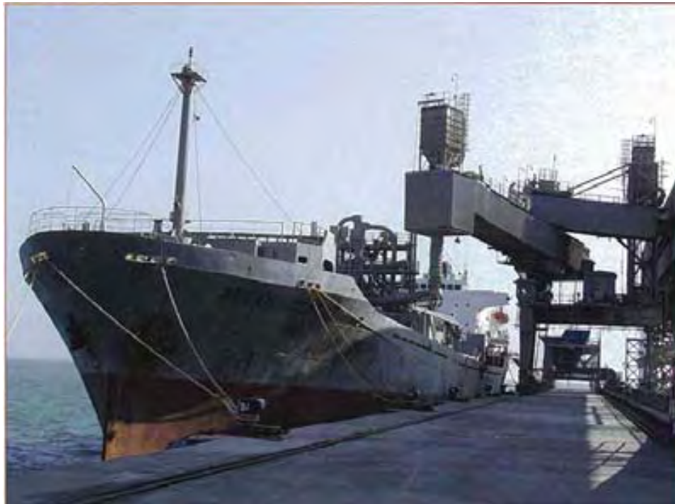
Figure 5-1 konvejeri me ryp nga magazine ne ngarkusen e klinkerit
