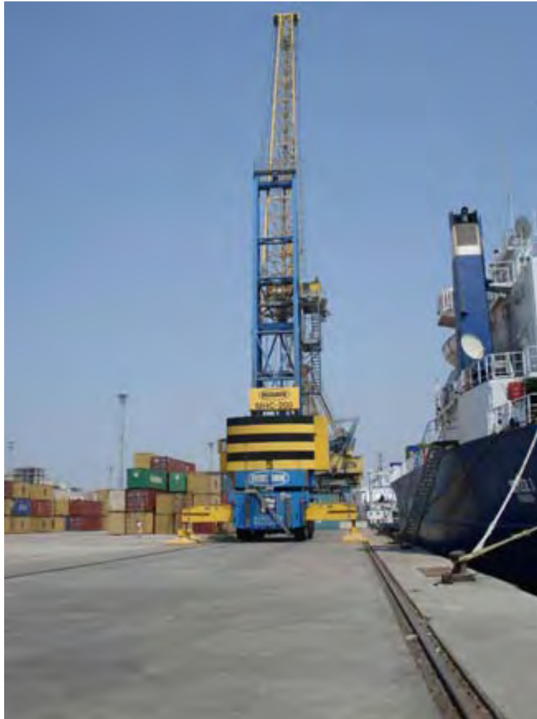
Figure 2-8 Vinçi me goma (Fantuzzi-Reggiane MHC 200 )qe perdoret aktualisht per perpunimin e kontenierave
