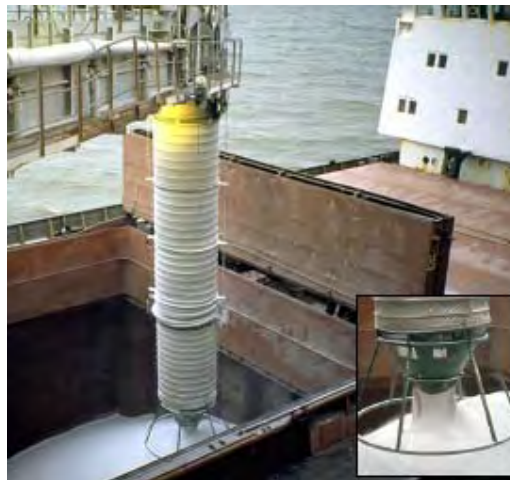
Figure 5-2 Tipi Cascade per parandalimin e pluhurit gjate operacionit te ngarkimit
