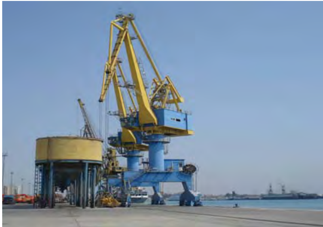
Figura 2-10 Vinçat e kalates per perpunimin e drithrave (Reggiane - 10t x 30m)
