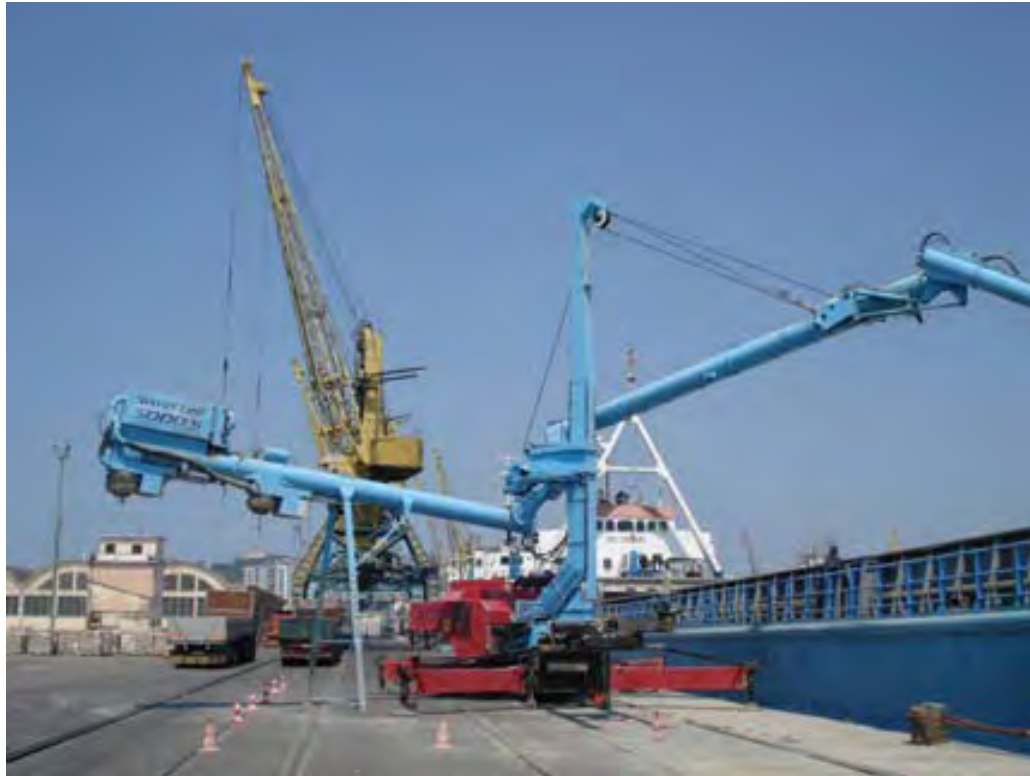
Figura 2-11 Shnek per shkarkimi e cimentos rifuxho (kalata 1)
