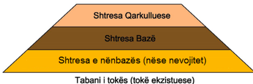
Figura 4.1: Seksion tërthor tipik për një shtresë fleksibël
