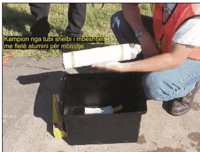
Figura 1.24: Tuba ambalazhues alumini për mbrojtjen e kampioneve te tubit Shelbi.
