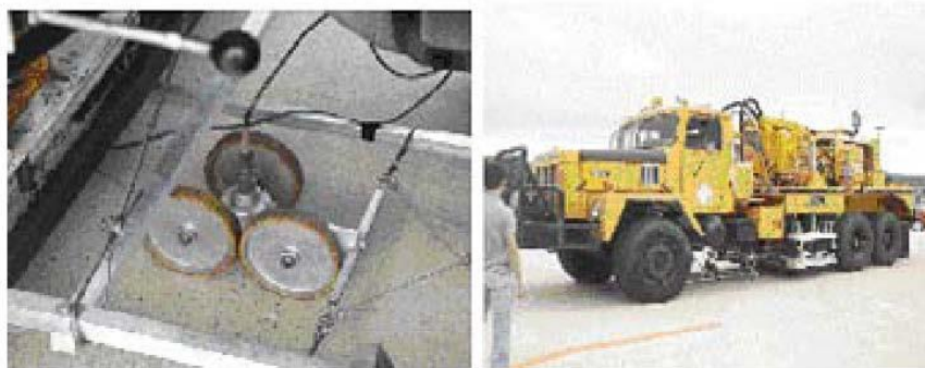
Figura 1.15: Deflektometri Dinamik me Rrota (DDR), skica me pjesët e emërtuara, rrotat e ngarkesës dhe fotografia
