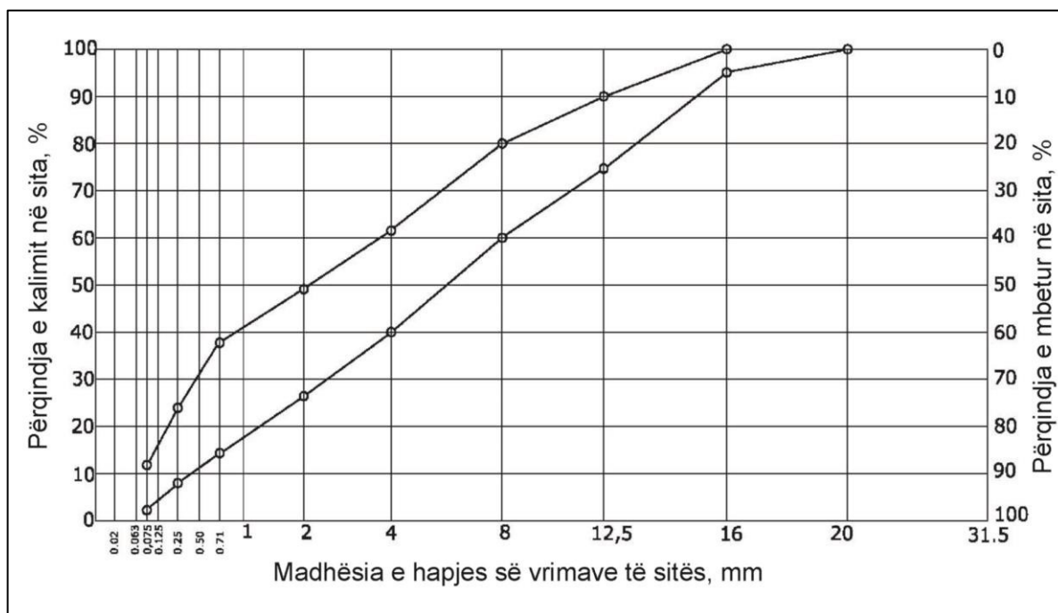
Figura 3.6: Kufijtë e formimit të përzierjeve të materialit inerte për ShSLS prej asfaltobetoni të tipit AB 16
