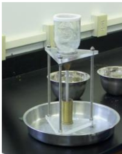
Figura 8.13: Prova e Këndit të thyerjes së Agregatit të Imët
