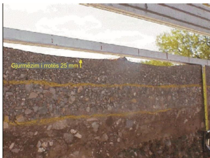
Figura 1.17: Mure anësore te kanalit qe tregojnë përkulje te forte
